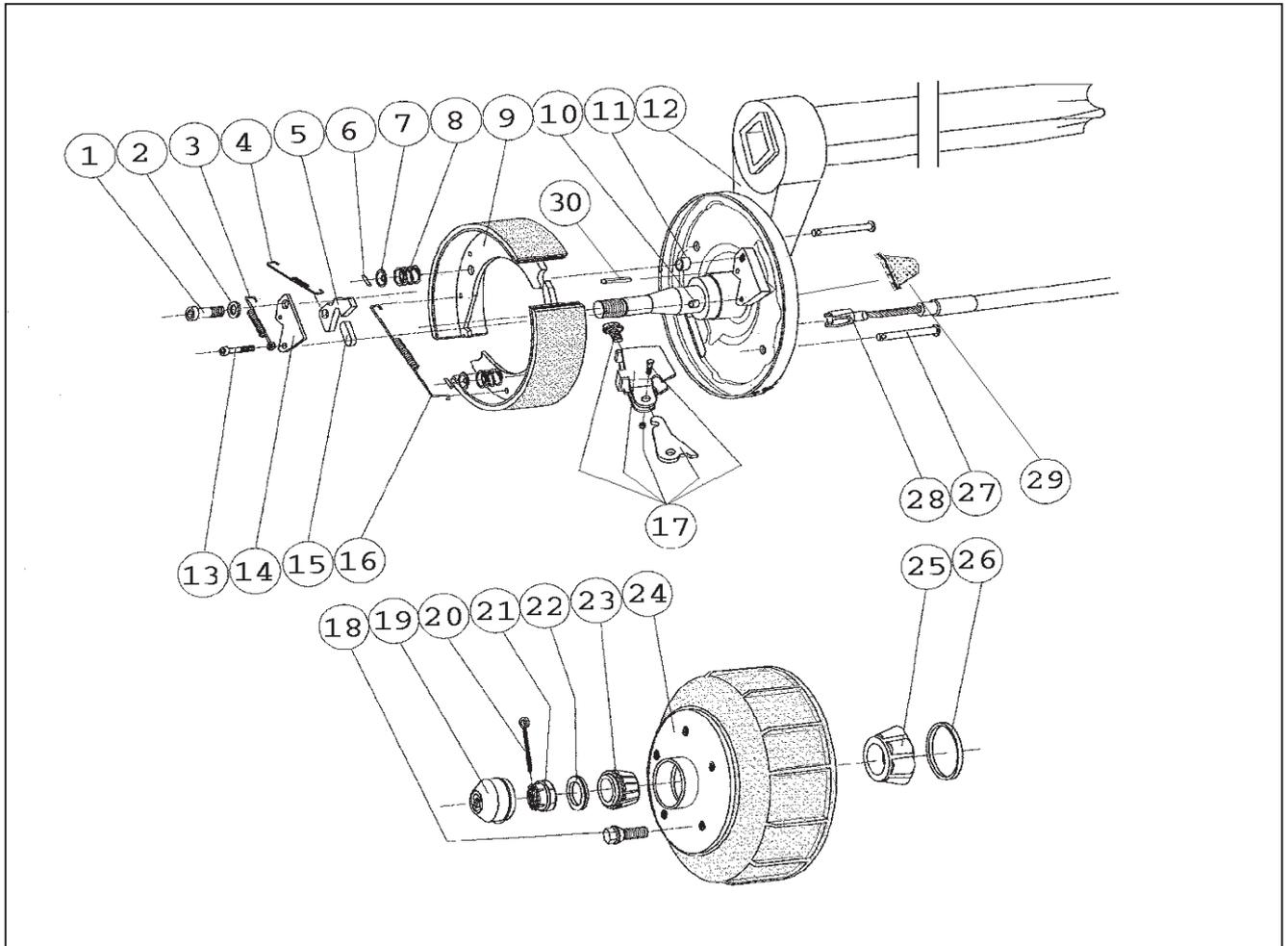
**Radbremse 200x50 ALTE-Baureihe SGB**
